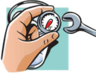
3. إذا كان ميزان الحرارة يحتوي على صمولة معايرة، فاستخدم مفتاح ربط صغير لقلبه حتى تقرأ درجة الحرارة 0 درجة مئوية (32 درجة فهرنهايت). ابقِ المجسّ في الماء المثلج للتأكد من دقة درجة الحرارة.
