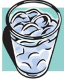
1. لاستخدام طريقة نقطة الجليد، امزج خليط من الثلج المجروش والماء بنسبة 50/50. ستكون درجة حرارة المزيج دائما 0 درجة مئوية (32 درجة فهرنهايت)، لذا يمكنك استخدام هذا للتأكد من أن ميزان الحرارة يعطي قراءة دقيقة.
